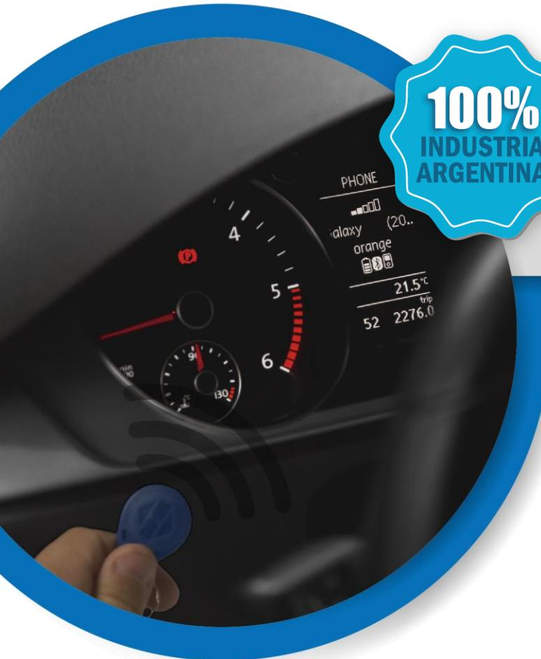
Ciertos dispositivos de rastreo vehicular, además de la función básica, permiten la incorporación de un lector de alguna tecnología, de modo que el conductor deba marcar con su tarjeta de proximidad previo al encendido del vehículo.
